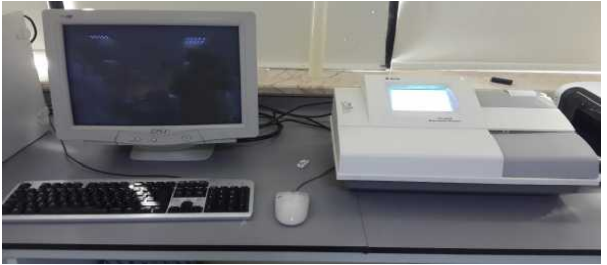
ekil 3.2. Kortizol analizi esnasında kullanılan RAYTO marka RT-6000 ELISA READER
